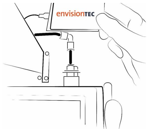
ABB. 3 ENVISION ONE CDLM - PLATZIERUNG DES MATERIAL-ANHÄNGERS
